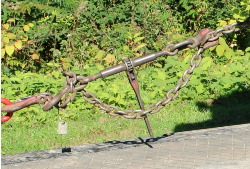
Foto 2 (Ratschlastspanner im Einsatz)
