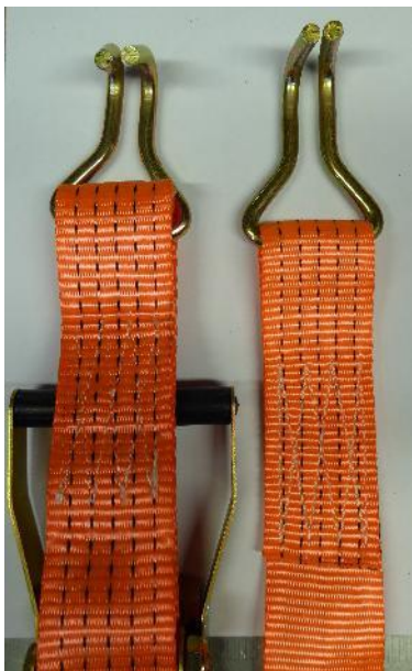
Bild 1: Die Profilhaken sind bereits vor Erreichen der LC aufgebogen. (Foto: FSA)
