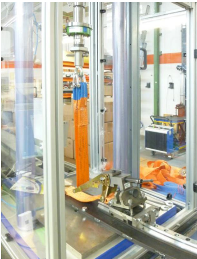
Foto 1 (Zurrmittel im Test – Belastungsprobe eines Handhebels) Der FSA testete zahlreiche Zurrmittel und deckte teils erhebliche Mängel auf.
